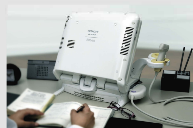
Панель управления переворачивается для большего рабочего пространства на столе
